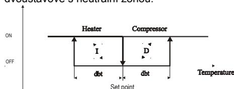
**Topení :** výstup se sepne při dosažení teploty "SET TEMP - dbt" a vypne při dosažení žádané hodnoty SET TEMP.
