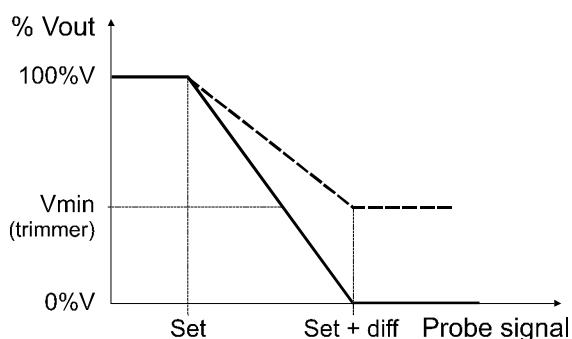
Je-li vstupní signál nižší než žádaná hodnota Set, výstupní signál je 230V (ventilátor běží na plné otáčky). Pokud se vstupní signál zvětší na hodnotu v rozsahu Set až Set+diff, výstupní signál sleduje teplotní (tlakové) změny. Nad hodnotou Set+diff je výstupní signál vždy 0 V ( pokud nejsou nastaveny minimální otáčky trimrem „minimum „speed““ ).
