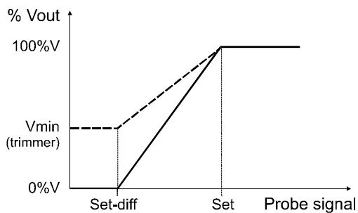
Je-li vstupní signál vyšší než žádaná hodnota Set, výstupní signál je 230V (ventilátor běží na plné otáčky). Pokud se vstupní signál zmenší na hodnotu v rozsahu Set až Set-diff, výstupní signál sleduje teplotní (tlakové) změny. Pod hodnotou Set-diff je výstupní signál vždy 0 V ( pokud nejsou nastaveny minimální otáčky trimrem „minimum „speed““ ).
